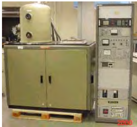
Figura 1.7. Evaporadora de alto vacío Balzers BA-510 utilizada para realizar la deposición del paladio en la cintura de la fibra estirada.
