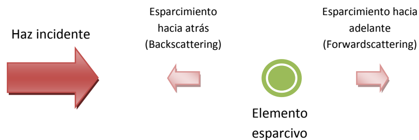
Figura 2.2 Representación del backscattering o esparcimiento hacia atrás; es la luz que se dispersa en la misma dirección del haz incidente, pero con sentido opuesto.
