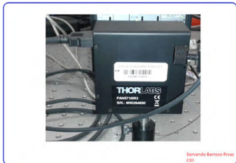
FIG. 3.5 CABEZA PAN7510 IR3 CON SENSOR EN EL RANGO IR3 (1300 NM A 1700NM)
