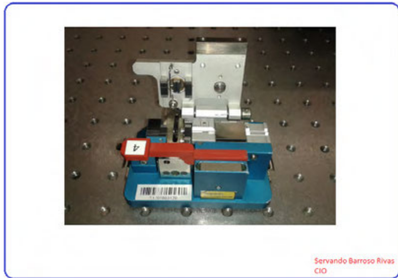
FIG. 3.9 CORTADORA DE FIBRA MARCA FITEL/FURUKAWA.
