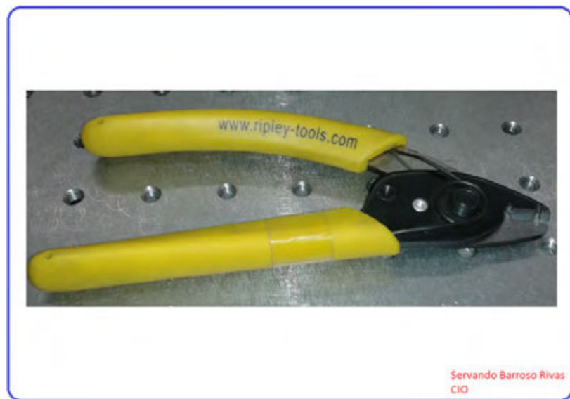
FIG. 3.8 PELADORA AJUSTABLE PARA CUBIERTAS DE FIBRAS.
