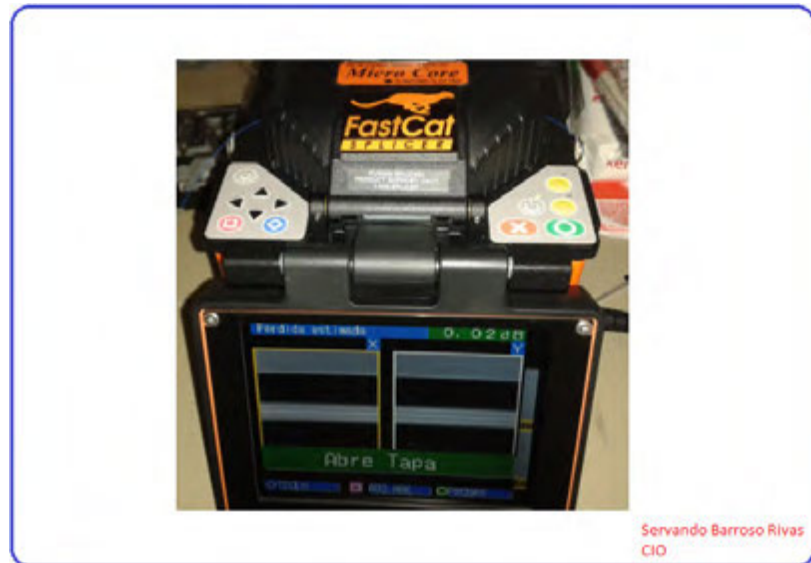
FIG. 3.18 FIBRA YA FUSIONADA CON SU PERDIDA ESTIMADA (0.02 dB).
