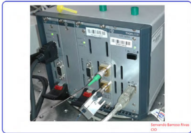
FIG. 3.6 PARTE IZQUIERDA: PAX5710 CONECTADO AL PAN5710 IR3, PARTE DERECHA: TXP5004 INTERFAZ A PC.
