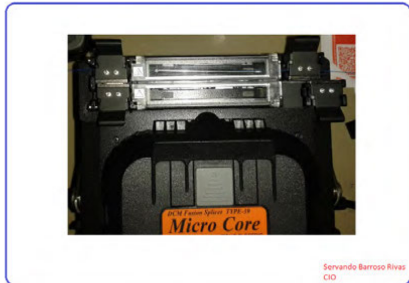
FIG. 3.19 CALENTADOR PARA AJUSTAR LA MANGA AL EMPALME.
