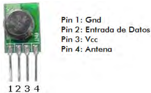
Figura 3.1.1: TWS 433 - TWS333. Los dos componentes de transmisión comparten la misma apariencia y configuración de pines.
