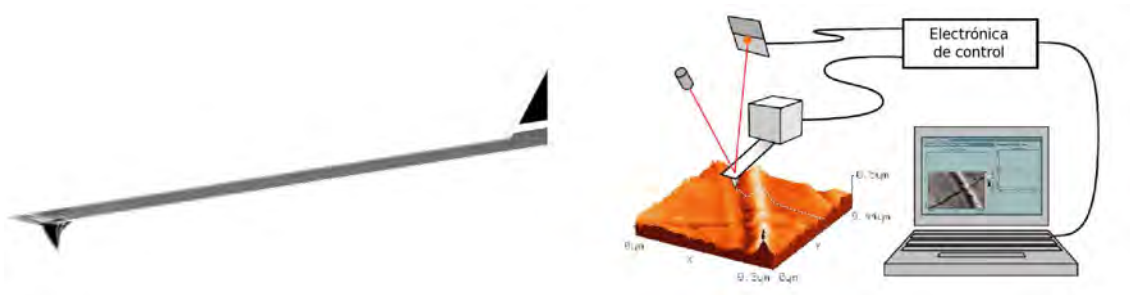
Figura 1.8: Izquierda: Cantilever de 228 \mu\text{m} de longitud fabricada en silicio con punta integrada. Derecha: Sistema de detección de deformaciones y control de posición del cantilever en operación.
