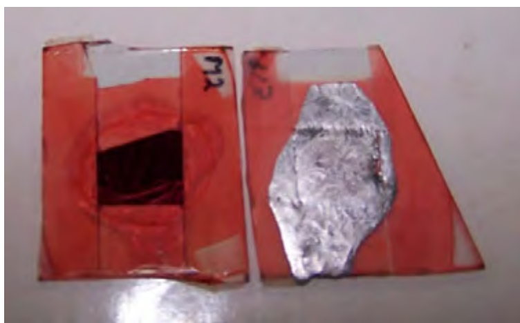
Figura 2.2: Fotografía de algunas de las celdas fabricadas. El área activa en la celda de la izquierda (zona oscura de la película) tiene un ancho aproximado de 1 cm. Se muestra el reverso (celda de la derecha) para dejar al descubierto el cátodo de Woods metal.
