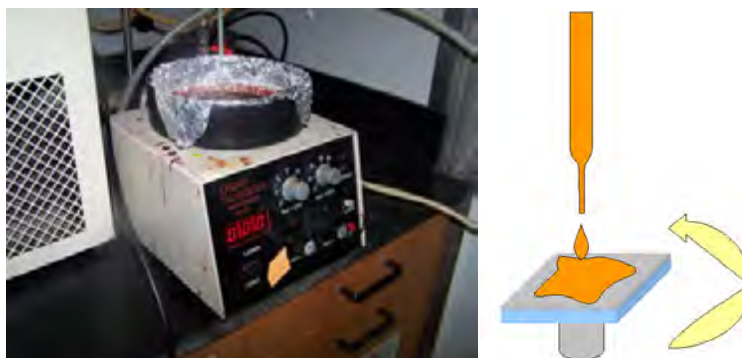
Figura 2.1: Dispositivo y técnica de spin-coating. Una porción de material orgánico en solución se coloca sobre el sustrato a recubrir (en este caso vidrio con ITO), rotándose para obtener una película delgada y uniforme.
