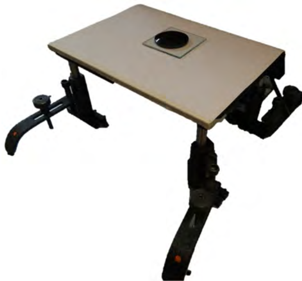
Figura 5. 5. Plataforma para la colocación del plano de referencia y el objeto.
