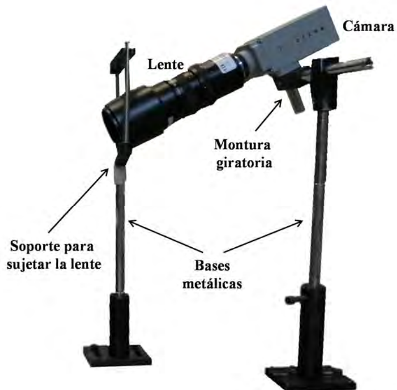
Figura 5. 2. Esquema del montaje para soportar la cámara y su lente.
