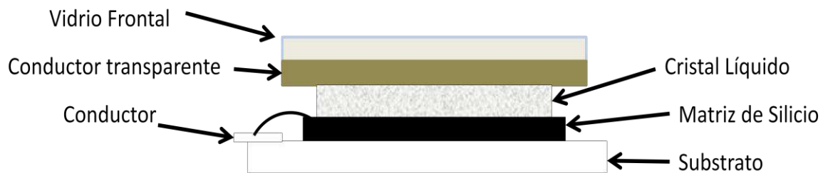
Figura 3-6. Estructura de un Cristal Líquido sobre Silicio (LCOS)
