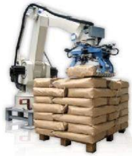
Figura 122.- Brazo robótico acomodando productos en un Pallet (Paletización)
