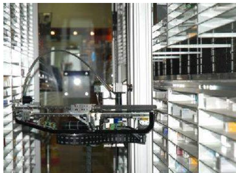
Figura 128.- Robot despachador de medicinas en medio de dos estantes
