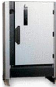
Figura 73.- Gabinete o consola de control del brazo robot
