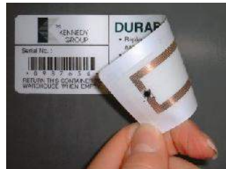
Figura 38.- Ejemplo de etiqueta pasiva
