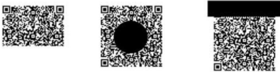
Figura 29.-Posibles pérdidas de datos que pueden ser recuperados por los algoritmos de corrección de errores
