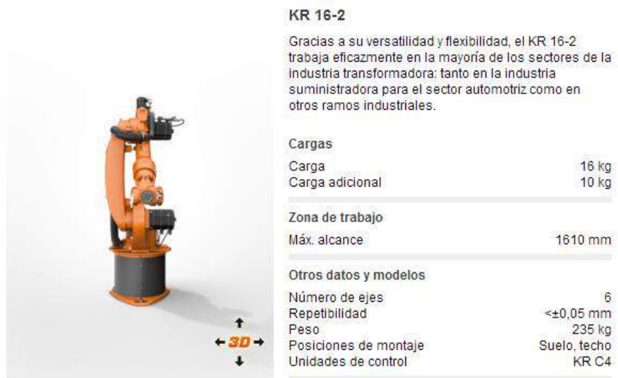
Figura 71.- Especificaciones técnicas del brazo robot [38]
