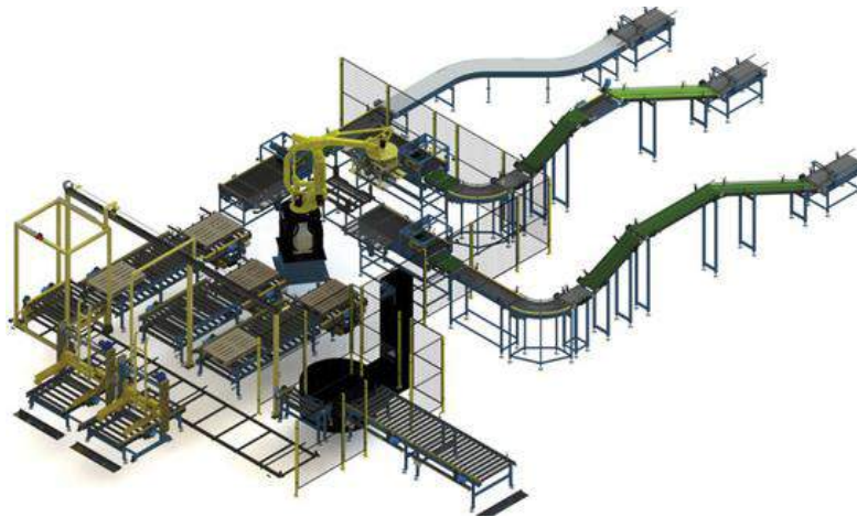
Figura 123.- Estación de paletización con tres entradas
