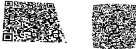
Figura 28.- Deformaciones comunes de la imagen de un símbolo QR
