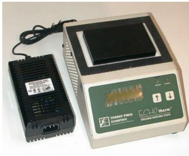
Figura 28. Placa con temperatura configurable de la compañía Torrey Pines Scientific.
