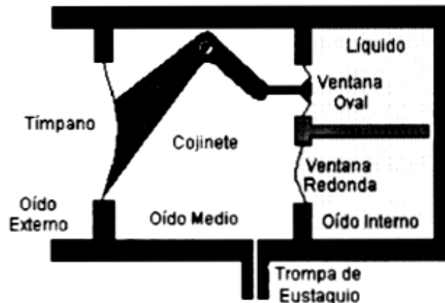
Figura 6 Esquema de Propagación del sonido a través del oído medio
