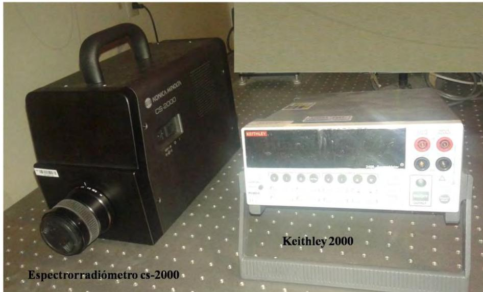
**Figura 2.4.** Espectrorradiómetro con el cual se midió el espectro de electroluminiscencia de los dispositivos, Keithley para encender los dispositivos a distintos voltajes.
