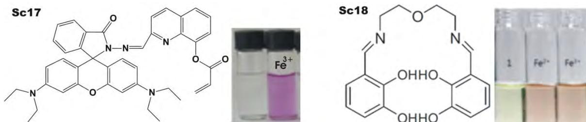
Figura 3.3. Moléculas orgánicas con capacidad de sensor colorimétrico de  $\text{Fe}^{2+}$  y  $\text{Fe}^{3+}$ .
