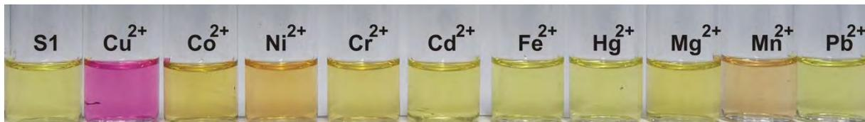
Figura 5.4. Fotografía de mezclas de soluciones de **S1** en ACN y diferentes iones metálicos disueltos en ACN/H<sub>2</sub>O (4:1, v/v). Tanto **S1** y los iones metálicos están a la concentración de  $2.5 \times 10^{-5}$ .
