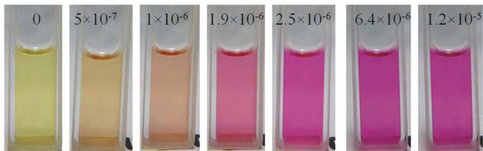
Figura 5.15. Cambios colorimétricos en **S1** después de agregar diferentes concentraciones de  $\text{Cu}^{2+}$ . La concentración de izquierda a derecha es de 0, 0.5, 1, 1.9, 2.5, 6.4, 12  $\mu\text{M}$ .
