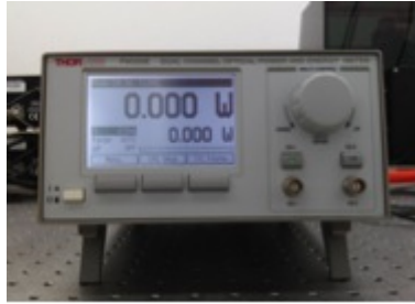
Figura 3.6: Potenciómetro marca Thorlabs modelo PM320E.
