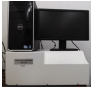
Figura 3.8: Módulo de control y monocromador del espectroelipsómetro.
