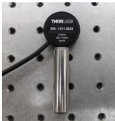
Figura 3.5: Fotodiodo de silicio modelo S120VC de la marca Thorlabs.
