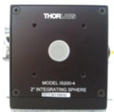
Figura 3.4: Esfera integradora Thorlabs modelo IS200-4.
