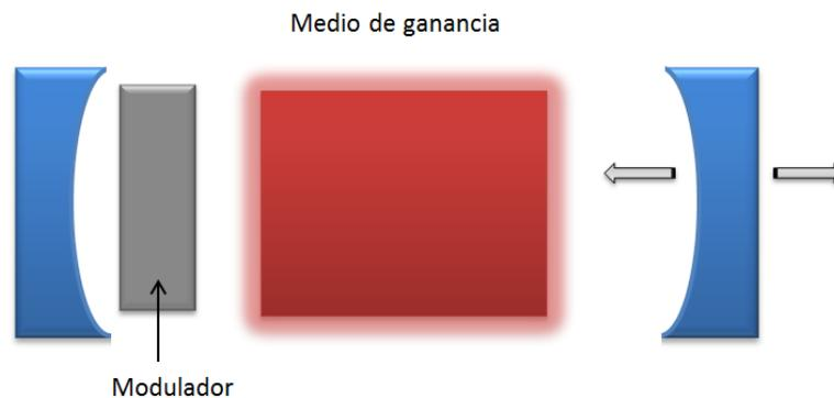
**Figura 3.3:** Esquema del láser en amarre de modos activo.
