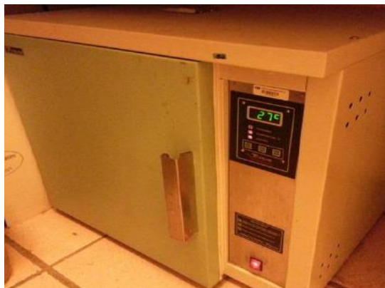
Figura 3.7 Horno de laboratorio utilizado para calentar la placa fenólica cubierta por capa de photoresist .
