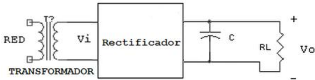
Figura A.20 Esquema de un filtro de condensador. [18]
