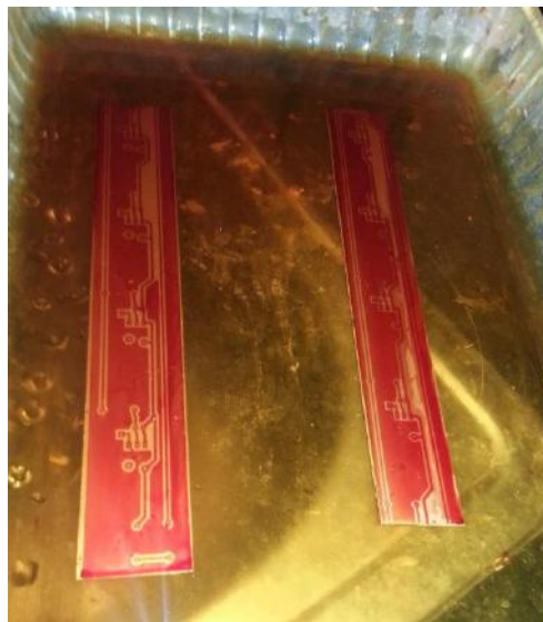
Figura 3.10 Placas sumergidas en solución reveladora.
