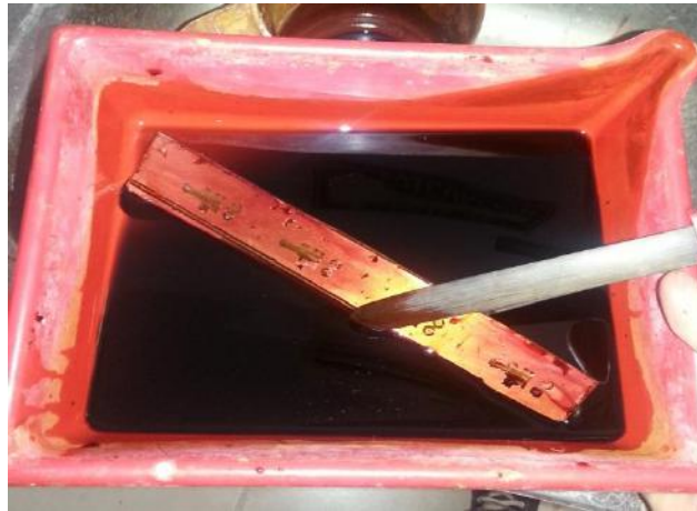
Figura 3.11 Placa sumergida en solución de cloruro férrico.
