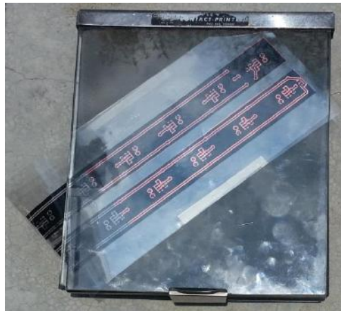
Figura 3.8 Hoja fotostática fijada sobre placa fenólica cubierta por capa de photoresist expuesta a fuente de luz ultra violeta (Sol).
