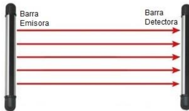
Figura 3.14 Tipo de emisión uno a uno en primer prototipo de Barrera de Seguridad Optoelectrónica.
