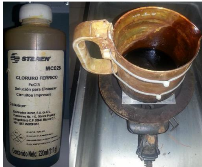
Figura 3.9 Disolución de cloruro férrico calentándose para su posterior utilización.
