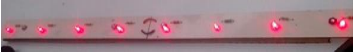
Figura 3.26 PCB manufacturada con fallas de alineación en sus componentes.
