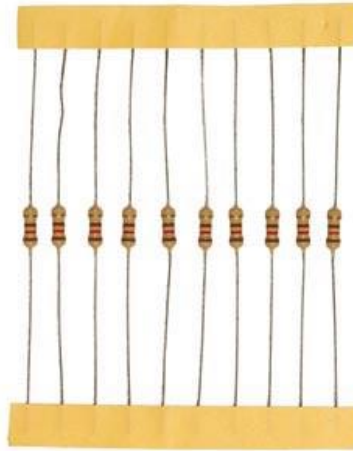
Figura 2.5 Resistencias de 330\Omega utilizadas en la barra emisora.
