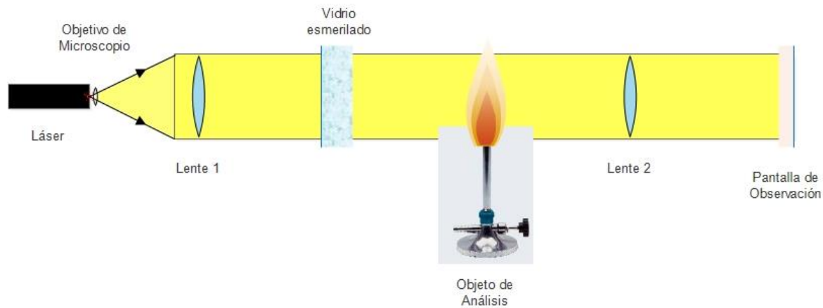
Figura 1-2 Arreglo experimental para la medición de ángulos de deflexión utilizando fotografía con moteado.
