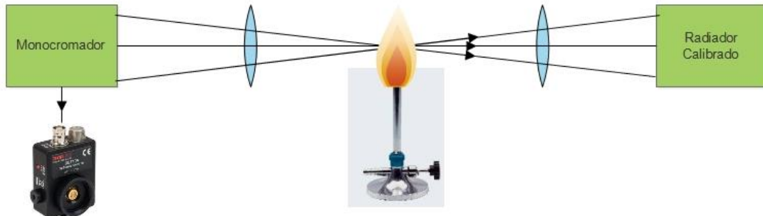
Figura 1-1 Esquema de un pirómetro óptico.
