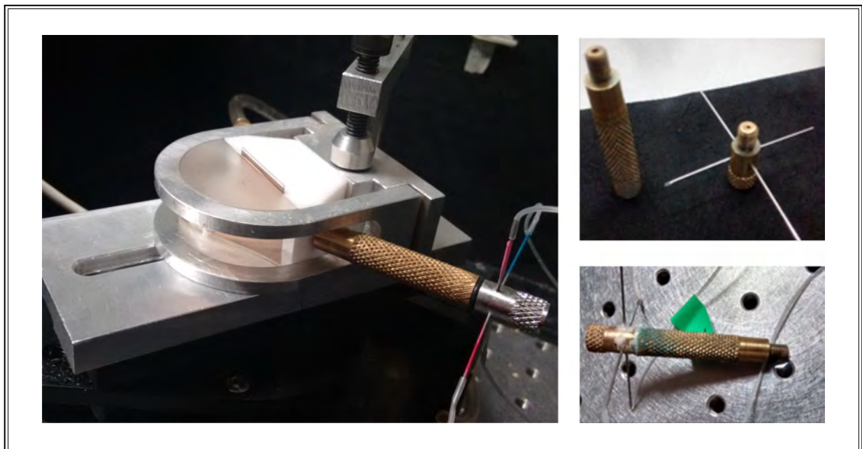
Figura 5.13: Vástagos de entrada y salida que se conectan a la microcelda.
