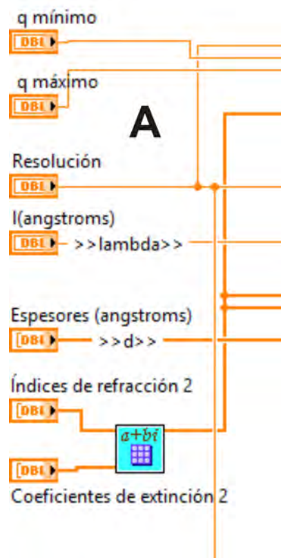
Figura 4.2: Parte A del código fuente para el cálculo de la curva teórica de RPS.
