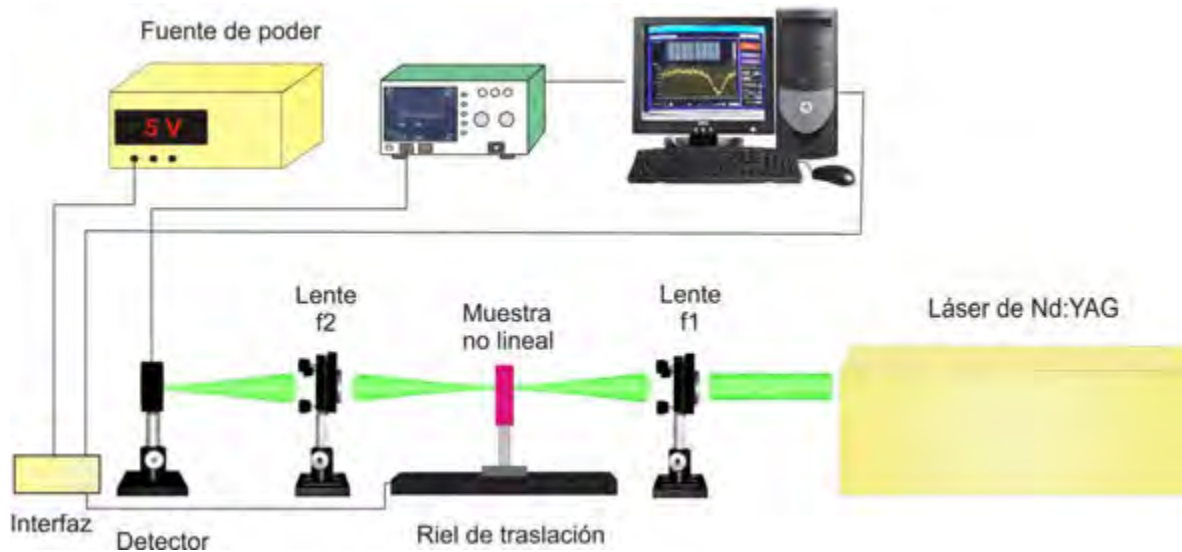
Figura 6.3. Arreglo de Z-scan de apertura abierta
