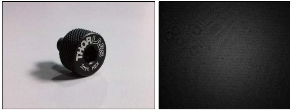
Fig. 4.3. a) Objeto utilizado para la grabación del holograma, b) Holograma del objeto grabado en la CCD.
