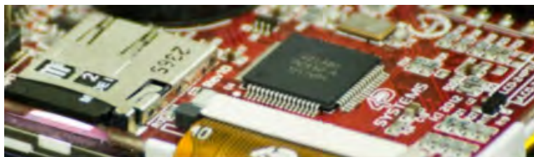
Figura 4.36: Colocación de la tarjeta micro - SD en la ranura del módulo de control de la pantalla.
