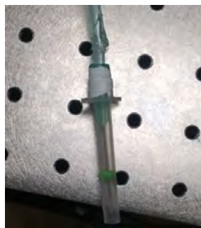
Figura 3.3: Fotografía de la cubierta protectora de los sensores.
