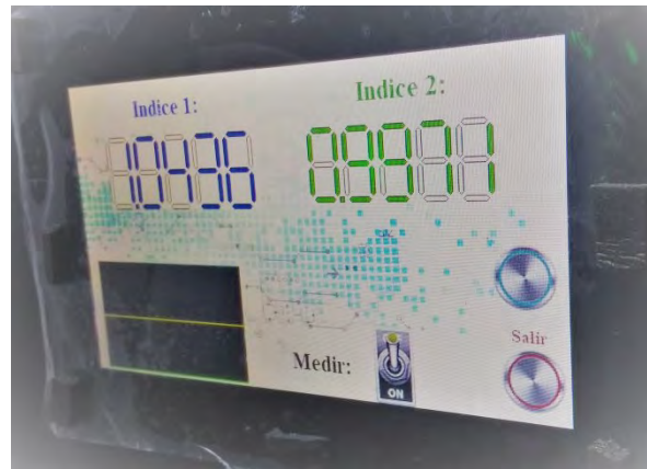
Figura 5.8: Pantalla de medición en funcionamiento. Muestra el valor de IR de los sensores en aire.
