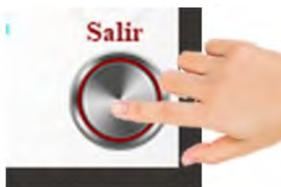
Figura 1.8: Botón salir, resetea el sistema y regresa a la pantalla de inicio.
