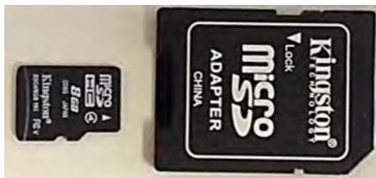
Figura 4.33: Tarjeta de memoria micro - SD, para cargar el contenido multimedia del programa.
