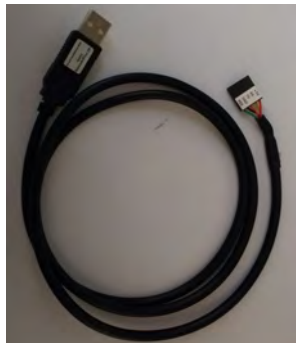
Figura 4.30: Cable de programación de la compañía 4D System, con las terminales de +5V, Rx, Tx, GND y RES para conectar al módulo de programación de la pantalla.
