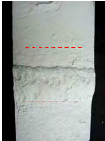
Figura 3.11 Daño en la parte inferior de la barra 2.
