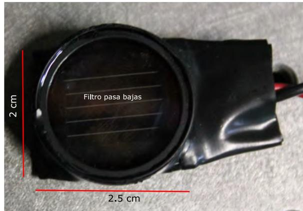
Figura 4.17: Celda solar con filtro pasabajas con longitud de onda de corte de 975 nm.
