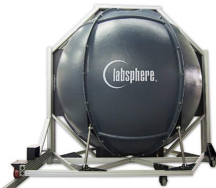
Figura 17. Esfera integradora de la marca Labsphere .
