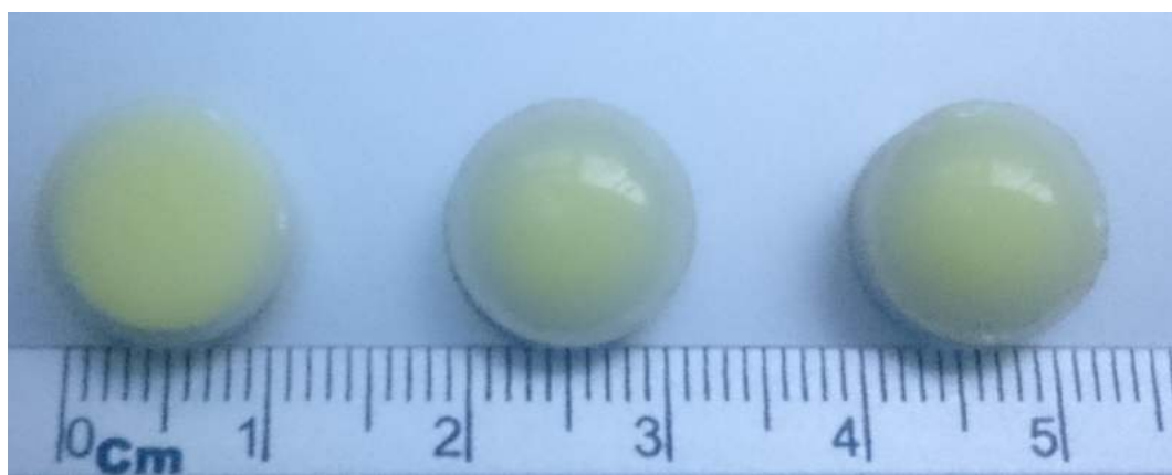
Figura 21. De izquierda a derecha se muestran PiG con diferente geometría, Plano, Semi esfera y domo.
