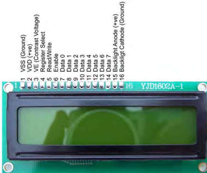
Apéndice A Figura 20. Diagrama de pines de la pantalla LCD 16x2 caracteres.
