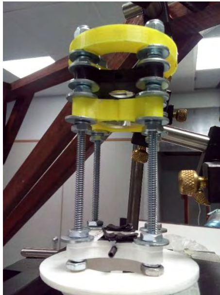
Figura 3.4. Sistema óptico de la hoja de luz en soportes.
