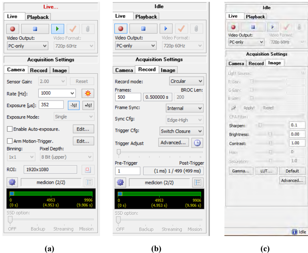
Figura 3.1. Interface de Motion Studio que controla los parámetros de la cámara Y7-S1
