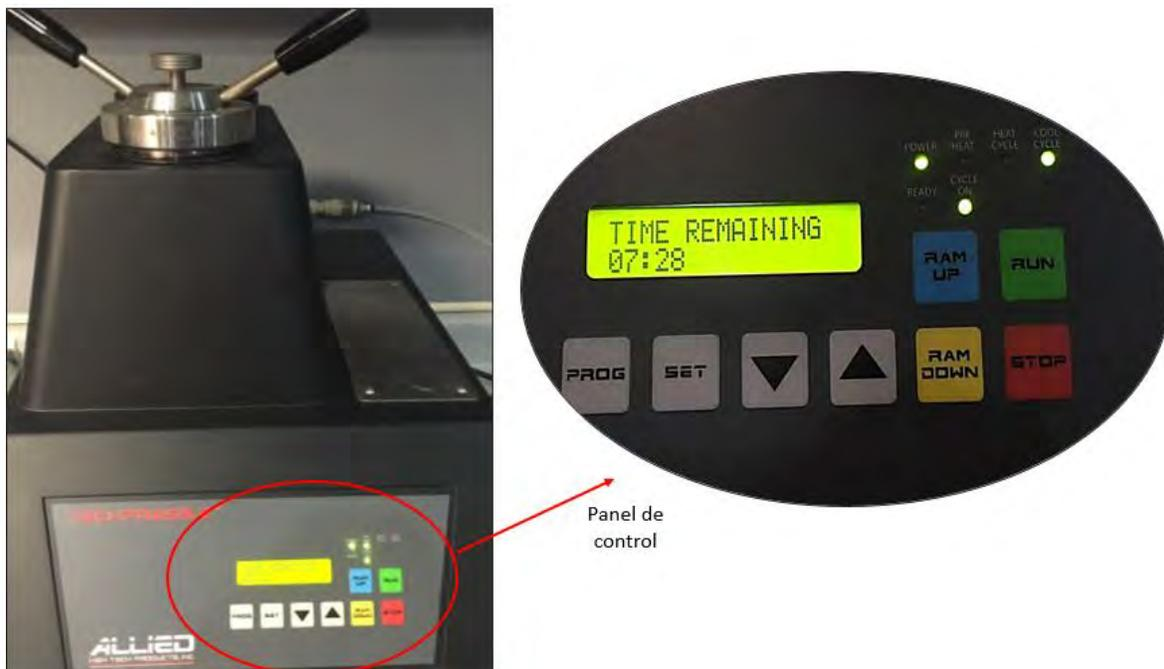
Figura 3.2 Fotografía del panel frontal de la montadora ALLIED Techpress 2 con indicadores de etapa.
