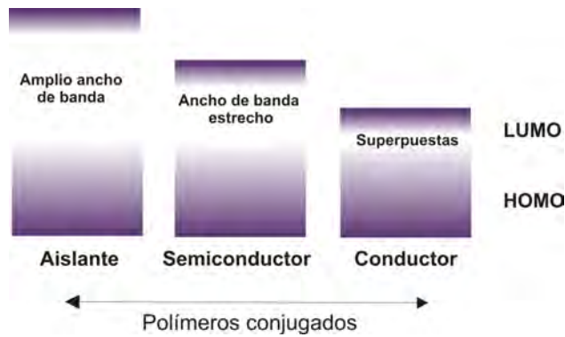
Figura 4.7: Imagen general de bandas de un aislante, semiconductor y metal y la comparación de la conductividad de los polimeros conjugados de esos materiales.
