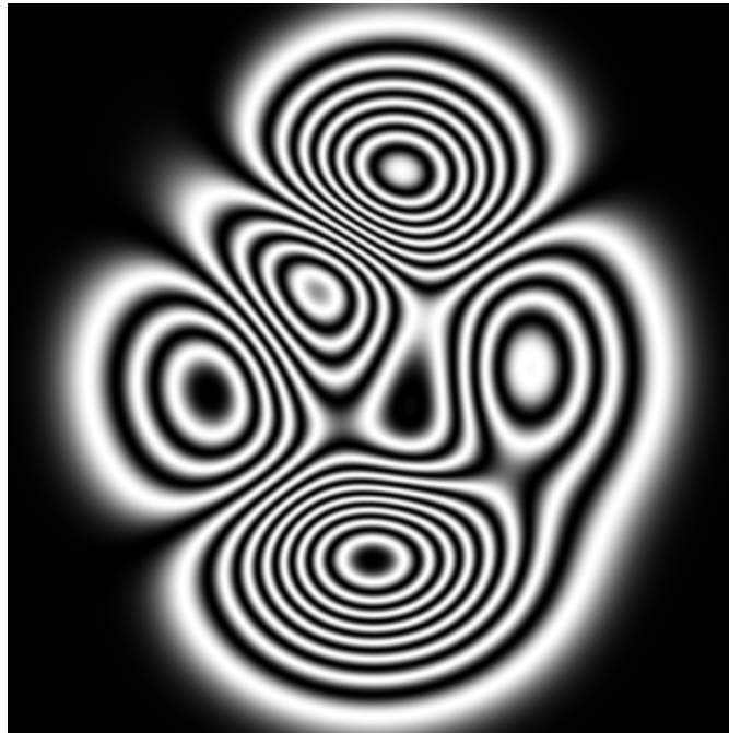
Figura 1.1: Simulación de un interferograma de franjas cerradas donde la diferencia de fase en el término de interferencia corresponde a la función peaks , una curva de prueba generada mediante translación y escalamiento de funciones gaussianas.
