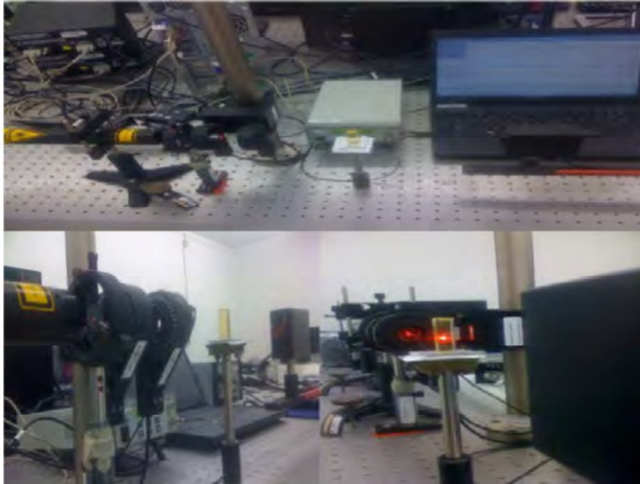
Figura 3.5. Imagen del arreglo óptico diseñado para el estudio polarimétrico de la miel. Fuente láser no polarizada de 632 nm, polarizador lineal Glan-Thomson, placa retardadora de cristal líquido variable, fuente de alimentación a la placa, cabeza de polarización o PSA con capacidad de trabajar en el rango de 400 nm a 700 nm (modelo PANVIS) y software de representación de estados de polarización.
