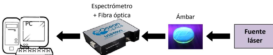
Fig. 3.7 Arreglo utilizado para medir el espectro de emisión fluorescente del ámbar.
