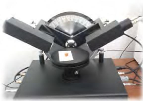
**Fig. 3.2** Muestra de ámbar posicionada en la platina del espectroelipsómetro.
