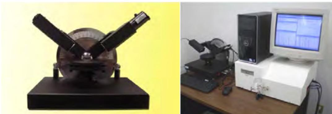
Fig. 3.1 Espectroelipsómetro.
