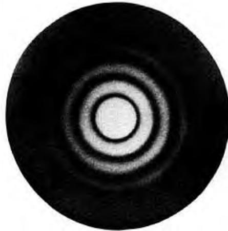
Figura B.16. Patrón de difracción que forma una rendija circular.
