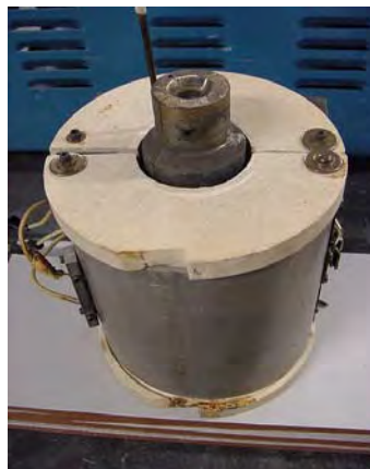
Figura 5.2 Fotografía del horno que produce el calentamiento del Molde de latón.
