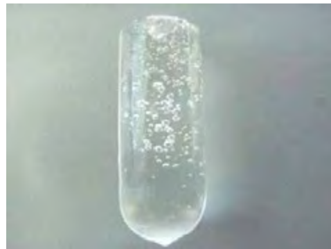
Figura 5.5 Burbujas en el interior de la preforma
