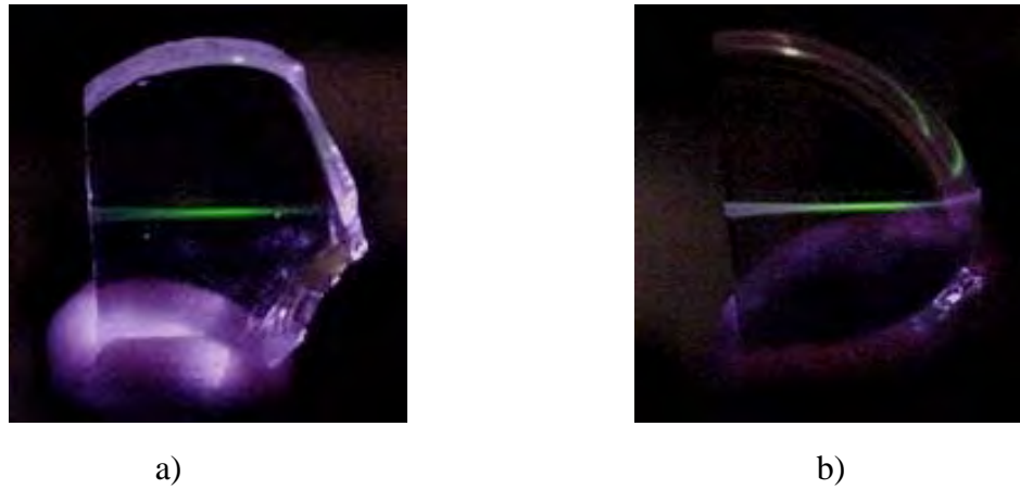
Figura 4.9 Fotografía de la Conversión Hacia Arriba en un Vidrio de Telurio Dopado con \text{Er}^{3+} a) Dopado al 0.5%, b) Dopado al 3%.
