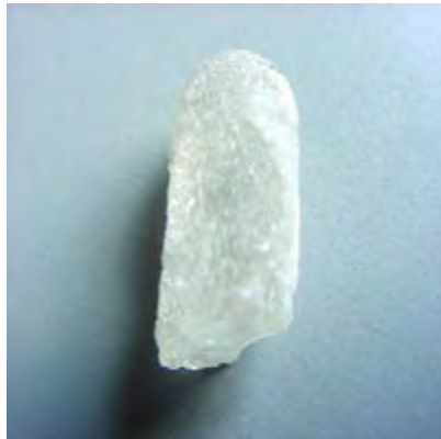
Figura 5.6 Cristalización y burbujas alrededor de la preforma
