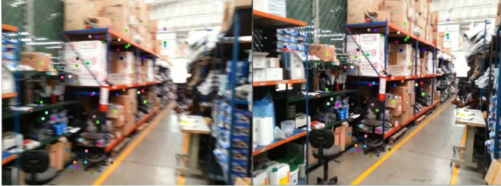
Figura 4.2: Ejemplo de emparejamientos resultando de la clase geneticMatcher . En la imagen, se aíslan algunos emparejamientos para un par de imágenes. Cada par de puntos emparejados se resalta con un color diferente. Se hace notar que una buena cantidad de puntos no fueron emparejados, sin embargo los que sí lo fueron son buenos emparejamientos.
