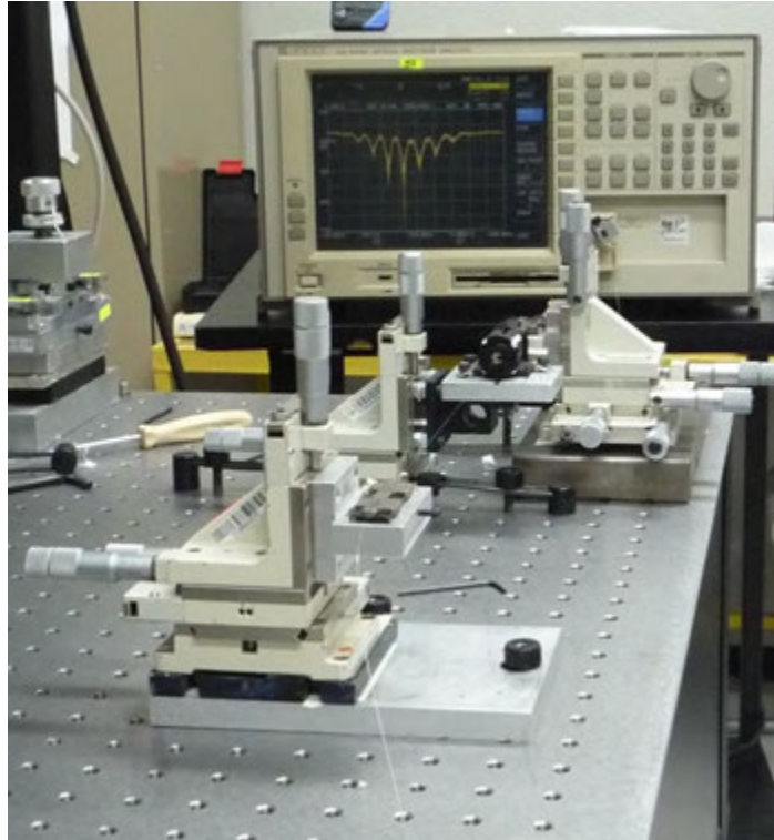
Figura 4.16 (a) Esquema del arreglo experimental que se uso en la caracterización en torsión del IM-Z, (b) fotografía del arreglo.
