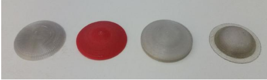
Figura 5.7: De izquierda a derecha: lente esférica de PS de f = 6 cm, lente esférica de ABS f = 6 cm, lente asférica de PS de f = 3 cm y lente esférica de PS de f = 3 cm.
