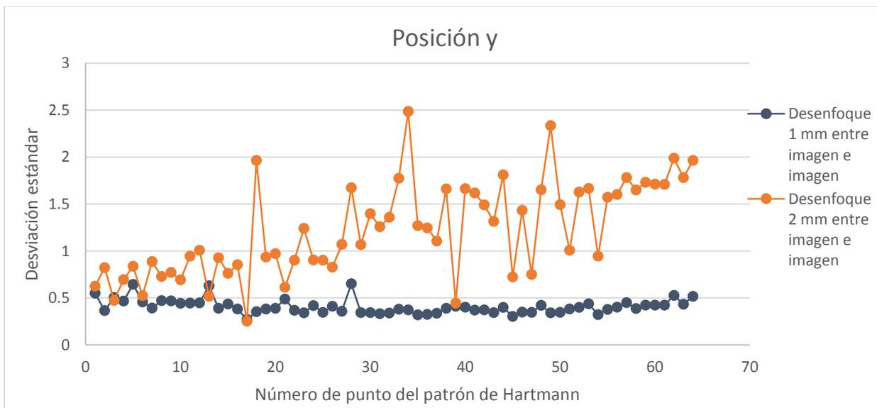
Figura 4.12: Desviación estándar calculada de la posición de los centroides (posición y), para cada conjunto de imágenes desenfocadas del patrón de Hartmann, obtenidas de un balín de 15.6 mm de diámetro, mediante el topógrafo corneal.
