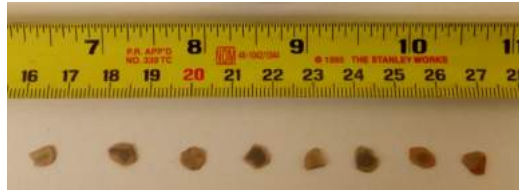
Figura 4.1: Sustrato Turface. En la parte inferior se pueden ver 8 rocas individuales del sustrato luego de que se aplanaran dos de sus caras hasta que quedaran paralelas.
