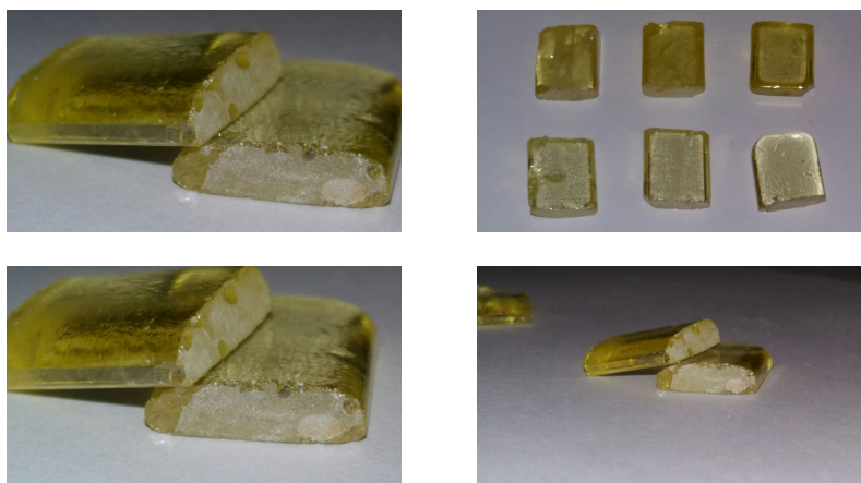
Figura 2.3: Fotografía de los bloques de vidrio cortados en partes de 1.5cm de largo. Sus superficies no son regulares por lo que es necesario un tratamiento de pulido para el estudio de las propiedades ópticas no lineales.
