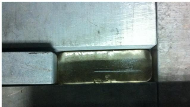
Figura 2.3: Vidrio vertido en placas precalentadas y en proceso de enfriamiento.
