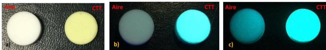
**Figura 3.18.** Imágenes de las pastillas de SAO dopado en AA y AC, a) como se observan las pastillas, b) como fluorescen las pastillas, c) como fosforescen las pastillas.
