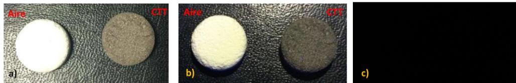
**Figura 3.14.** Imágenes de las pastillas de CAO dopado en AA y AC, a) como se observan las pastillas, b) como fluorescen las pastillas, c) como fosforescen las pastillas.
