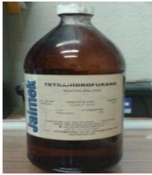
Figura 4.4 Tetrahidrofurano utilizado para remover el segundo revestimiento en la fibra DC.
