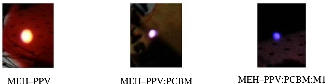
Figura 21. Extinción de la fluorescencia por la presencia de PCBM y la molécula M1. La fotografía a la izquierda muestra la emisión por fluorescencia en color naranja de la molécula MEH-PPV bajo una excitación de 400 nm. La fotografía central muestra la extinción de la fluorescencia parcialmente debido a la presencia del fulereno PCBM (relación 2:1 en peso). La fotografía a la derecha muestra la extinción total de fluorescencia en la molécula MEH-PPV debido a la presencia de la molécula M1 (relación 1:1 en peso).
