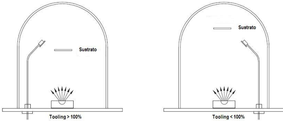
Figura 32. Por debajo del sensor se tiene un sensor tooling mayor al 100%, mientras que por encima se tiene un sensor tooling menor al 100%.
