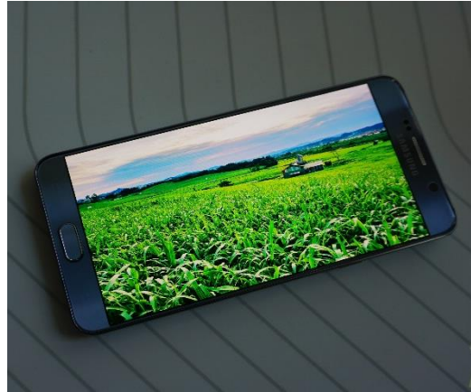
Figura 8. Smartphone Samsung Galaxy Note 5 cuya luminancia máxima alcanzada es de 861 \text{ cd/m}^2 .
