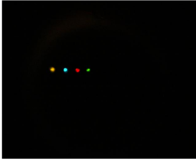
Figura 4.23 Manchas luminosas del Hartmanngrama
