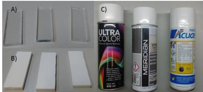
**Figura 3.9.** (a) Barras de acrílico de prueba. (b) Barras de acrílico pintadas de blanco mate de tres distintos tipos. (c) Pinturas de prueba.
