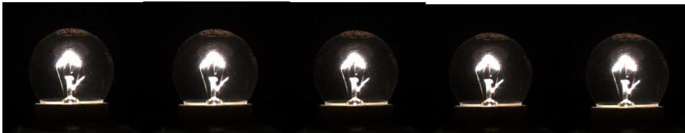
**Figura 3.49.** Imágenes de parpadeo lámpara incandescente Osram.
