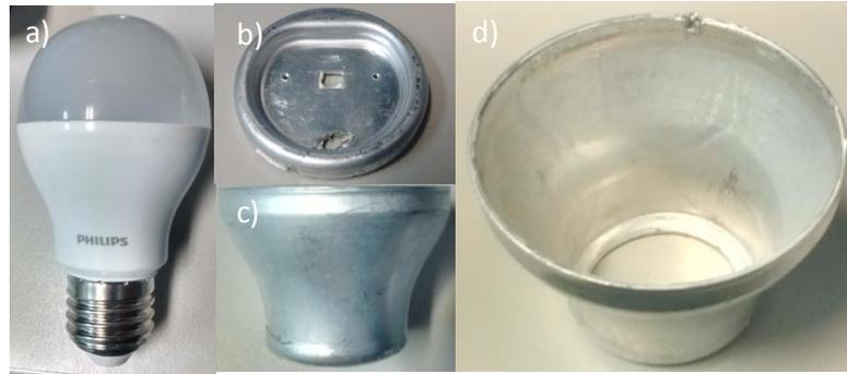
**Figura 3.14.** (a) Lámpara Philips de 9 W. (b) Disipador cubierta. (c)-(d) Imagen lateral y superior de disipador.
