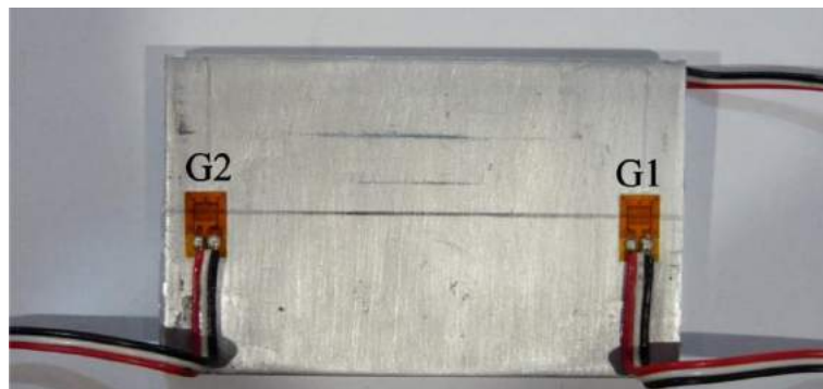
Figura 57: Probeta 4 con tres galgas extensiométricas, dos enfrente (galga 1 (G1) y galga 2 (G2)), y una por detrás (galga 3 (G3)).
