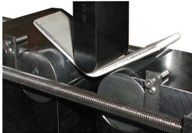
Figura 3: Probeta de metal sometida a un ensayo de flexión.
