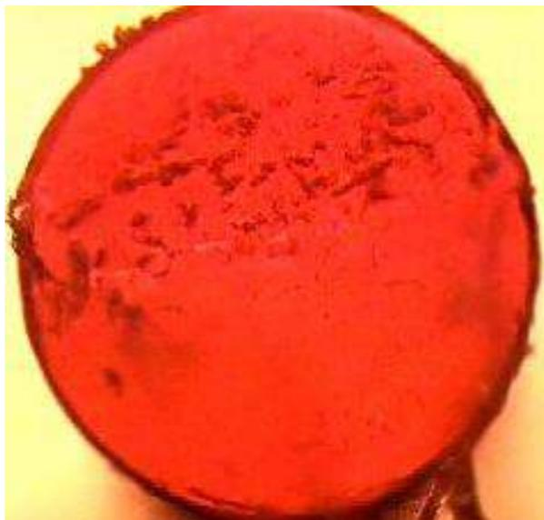
**Figura 3.14. Corte de la fibra óptica de plástico fluorescente vista a través del microscopio.**
