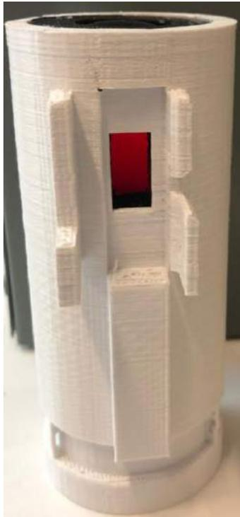
**Figura 4.11. Montura de la lente ocular enroscada completamente.**
