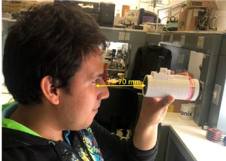
**Figura 4.18. Prototipo de mira réflex 2x25 con retícula iluminada por fibra óptica de plástico fluorescente con un alivio de ojo de 70 mm.**
