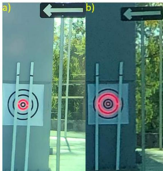
**Figura 4.26. Tamaño de la retícula iluminada. a) longitud de 25 m. b) longitud de 50 m.**
