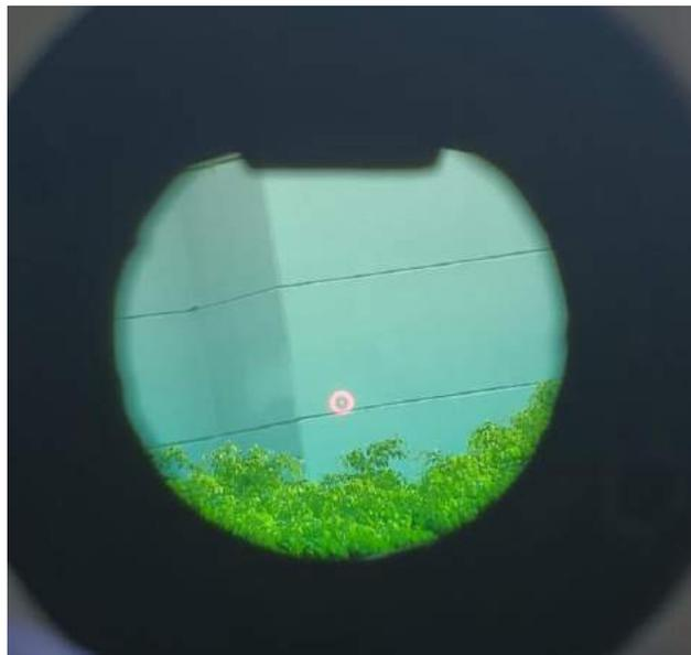
**Figura 4.19. Se observa la amplificación lateral de la imagen con la retícula iluminada vista a través de la lente ocular.**
