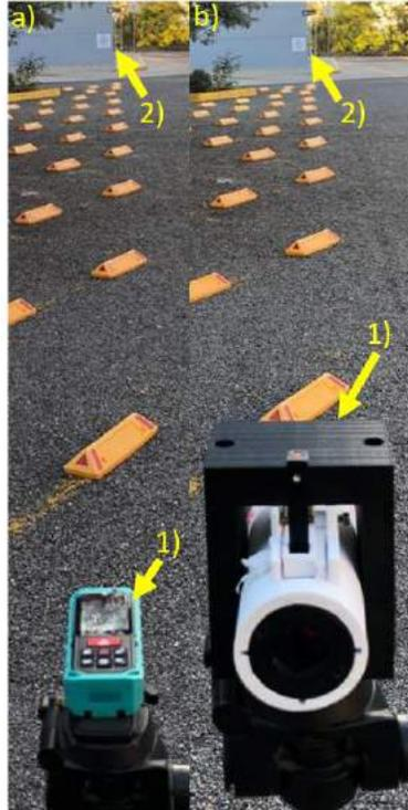
**Figura 4.24. Arreglo experimental para el campo de visión y tamaño de la retícula iluminada a 50 m. a) 1) Se colocó Mileseey-P7AK, 2) es la lona blanca de calibración para retícula iluminada de 60 cm x 60 cm. En b) 1) se colocó la mira réflex 2x25, 2) es la lona blanca de calibración para retícula iluminada de 60 cm x 60 cm.**
