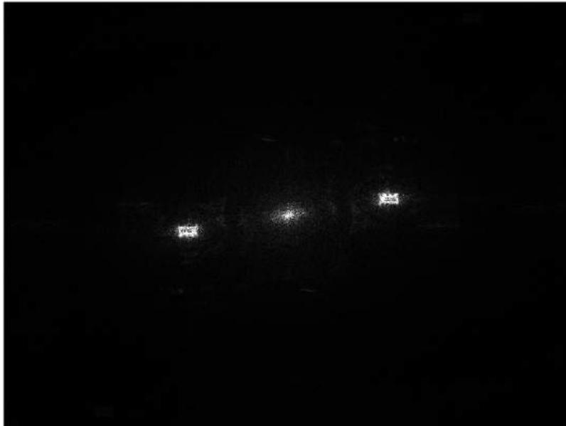
**Figure 2.2:** Transformada de Fourier de un holograma capturado utilizando la configuración holográfica fuera de eje en transmisión. La imagen muestra la separación espacial de las frecuencias generadas por la interferencia, lo que permite aislar con precisión las componentes de fase y amplitud necesarias para la reconstrucción digital.
