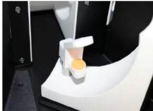
Figura 6. Ejemplo para la medición de polvos en iluminación directa [53].
