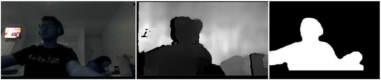
Figura 4.11: Cámara ZEDM con su mapa de profundidad y mascarâ semântica
