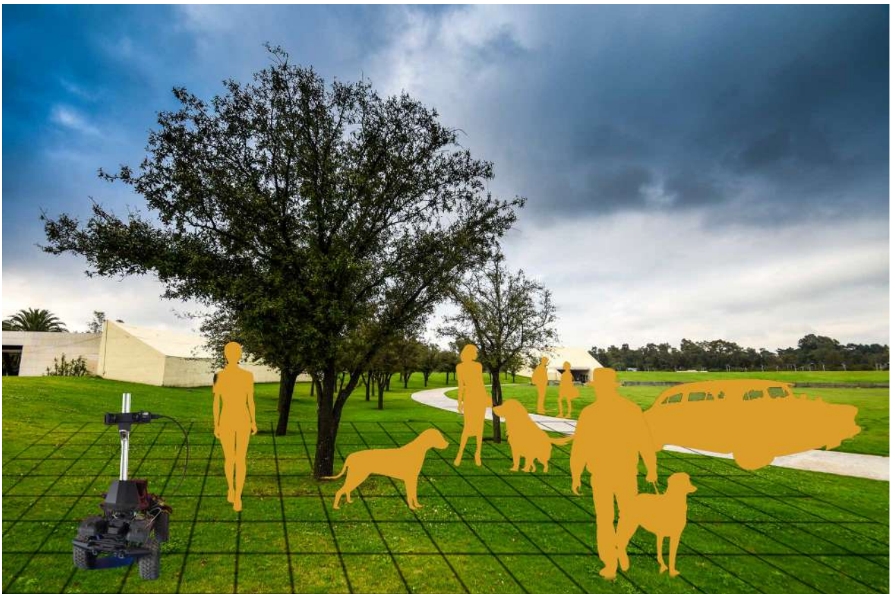
Figura 1.7: Representación de la plataforma de pruebas operando en un parque. Los objetos dinámicos (personas, mascotas, y un vehículo) identificados por el sistema aparecen resaltados en color naranja.
