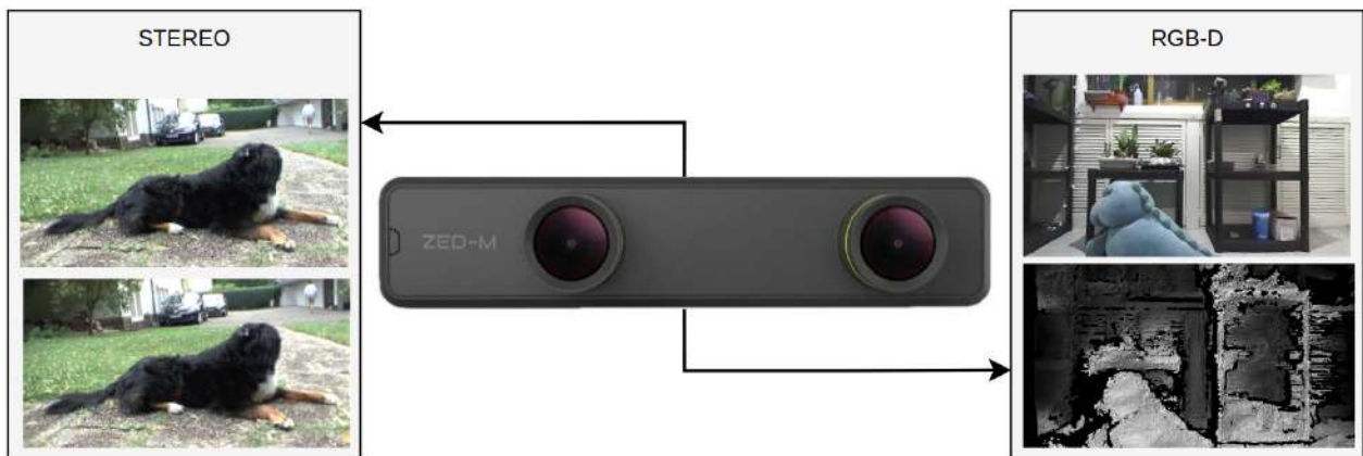
Figura 3.2: La figura ilustra cómo la cámara ZED combina la funcionalidad de las cámaras estéreo y RGB-D.
