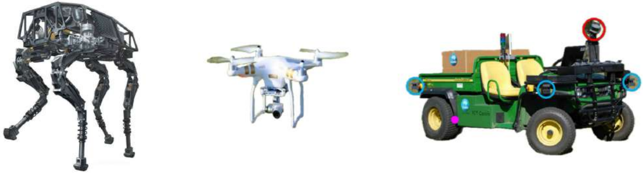
Figura 1.5: Las plataformas autónomas: un robot cuadrúpedo [1], un vehículo terrestre [2], y un dron [3], todos equipados con sensores visuales, están demostrando ser plataformas óptimas para explotar el Visual SLAM.
