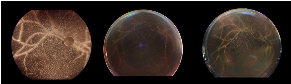
Figura 23. Comparación de imágenes del fondo de ojo plástico utilizando la cámara Versacam (izquierda), el prototipo utilizando la lupa oftálmica reutilizable (centro) y desechable (derecha). (Navarro-Saucedo et al., 2024)
